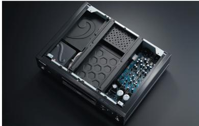
**Ultra-Starre Konstruktion mit Lüftungsloser oberer Stahlplatte und Aluminium Seitenteile**
