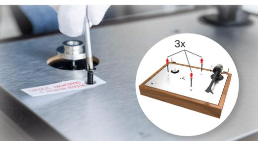
**15** Entfernen Sie die Schutzabdeckung der Achse.
