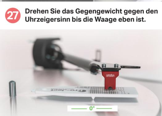
**27** Drehen Sie das Gegengewicht gegen den Uhrzeigersinn bis die Waage eben ist.
