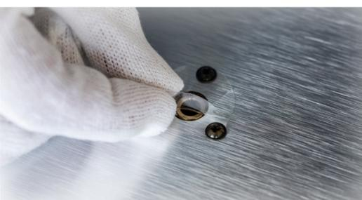
**16** Setzen Sie die Subplatter-Achse vorsichtig in das Lager.
