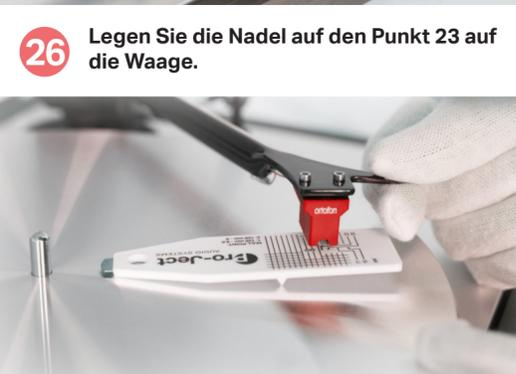
**26** Legen Sie die Nadel auf den Punkt 23 auf die Waage.
