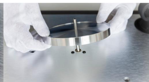
**17** Spannen Sie den Riemen um den Pulley und den Sub-Teller.
