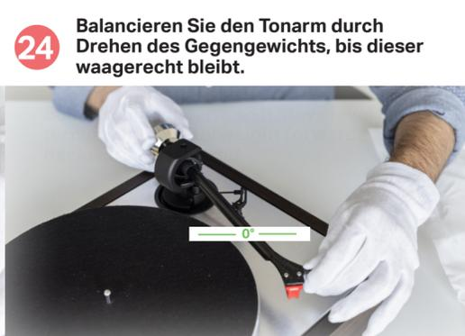
**24** Balancieren Sie den Tonarm durch Drehen des Gegengewichts, bis dieser waagrecht bleibt.
