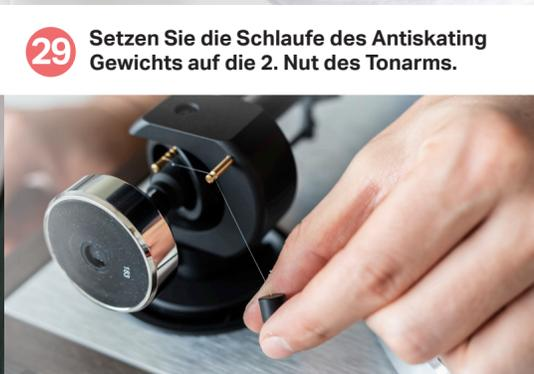
**29** Setzen Sie die Schlaufe des Antiskating Gewichts auf die 2. Nut des Tonarms.
