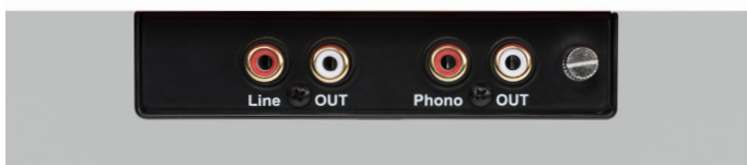
Separater Line und Phono Ausgang Ein/Ausschaltbarer BT-Sender (nicht abgebildet)
